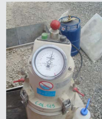
Het is essentieel het gehalte ingebrachte lucht van het beton te meten. Op vers beton, kan deze meting worden uitgevoerd door de drukmethode volgens de norm NBN EN 12350-7.
