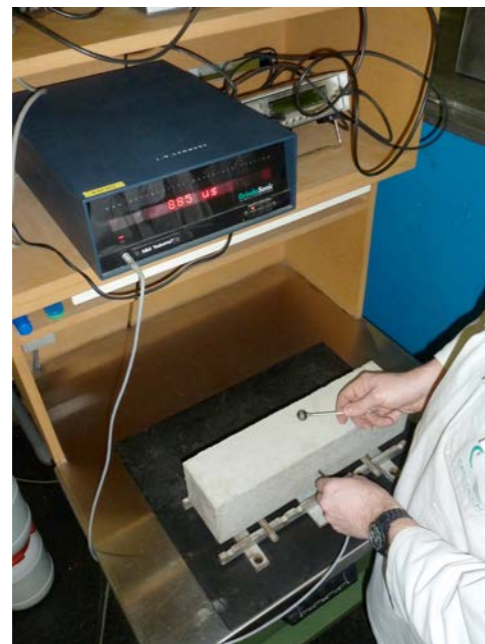
In trilling brengen bij buiging van een prismatisch proefstuk en meting van de resonantiefrequentie bij buiging.
